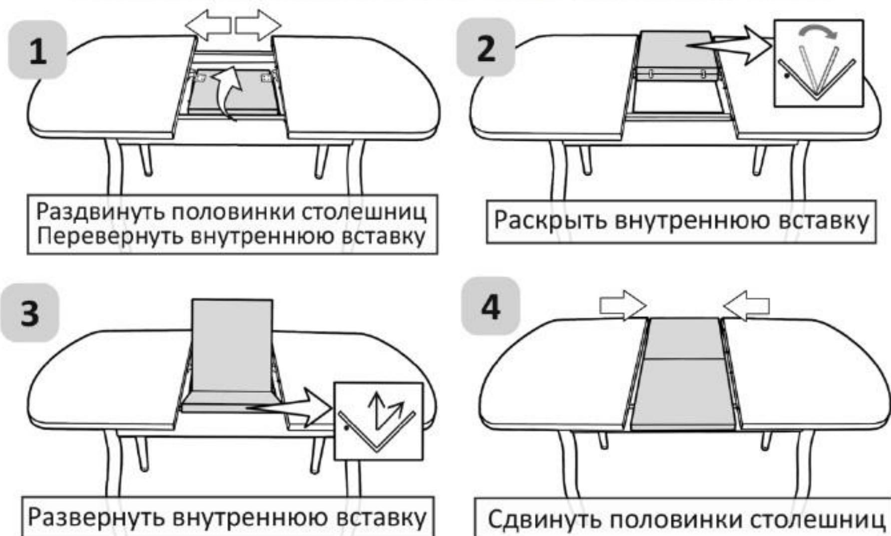
**ВАЖНО.** Во избежание самопроизвольного раздвижения половинок столешниц **ОБЯЗАТЕЛЬНО** переключите фиксаторы в состояние **ЗАКРЫТО**.
