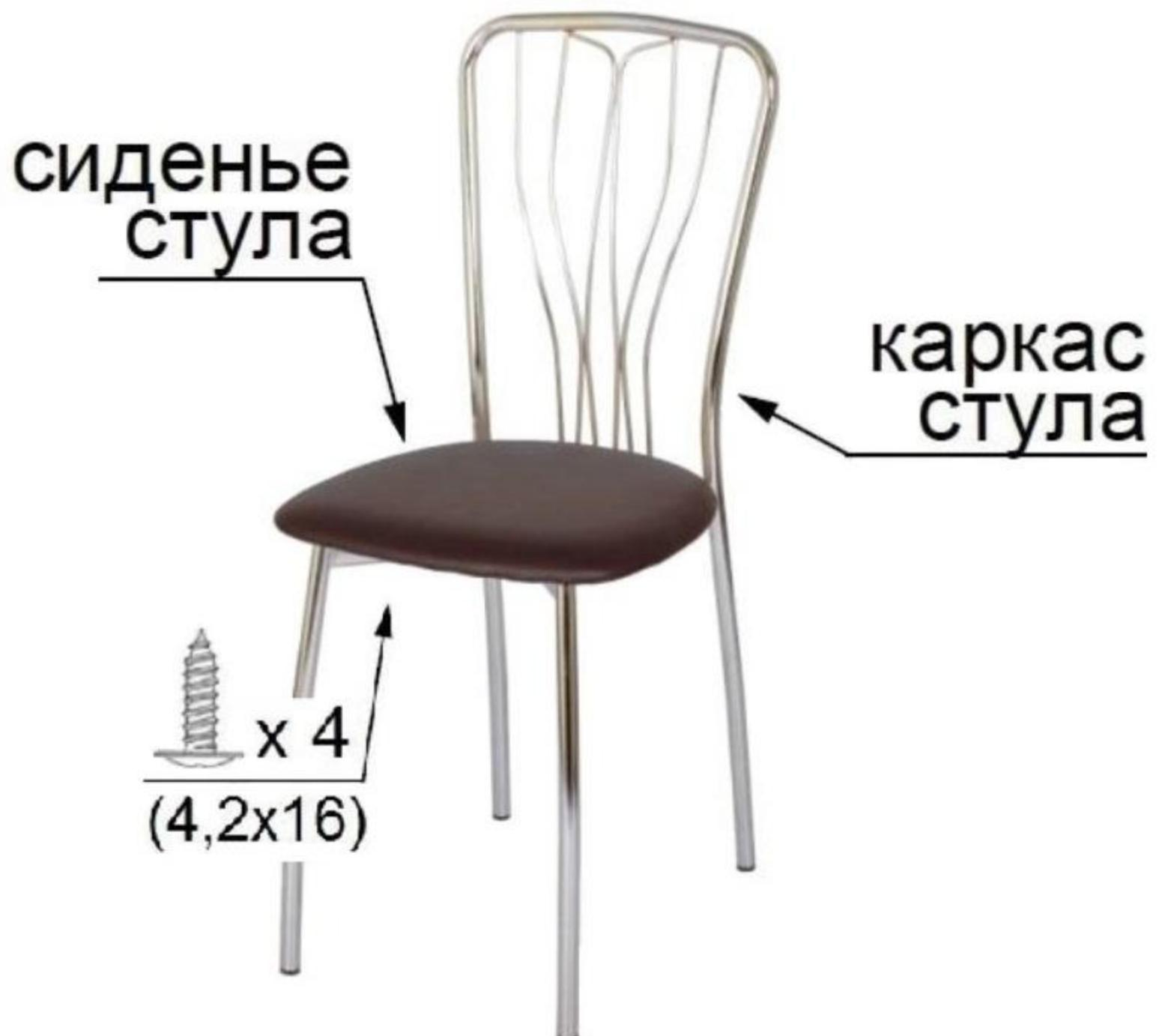
1. Установить сиденье стула на каркас стула.
