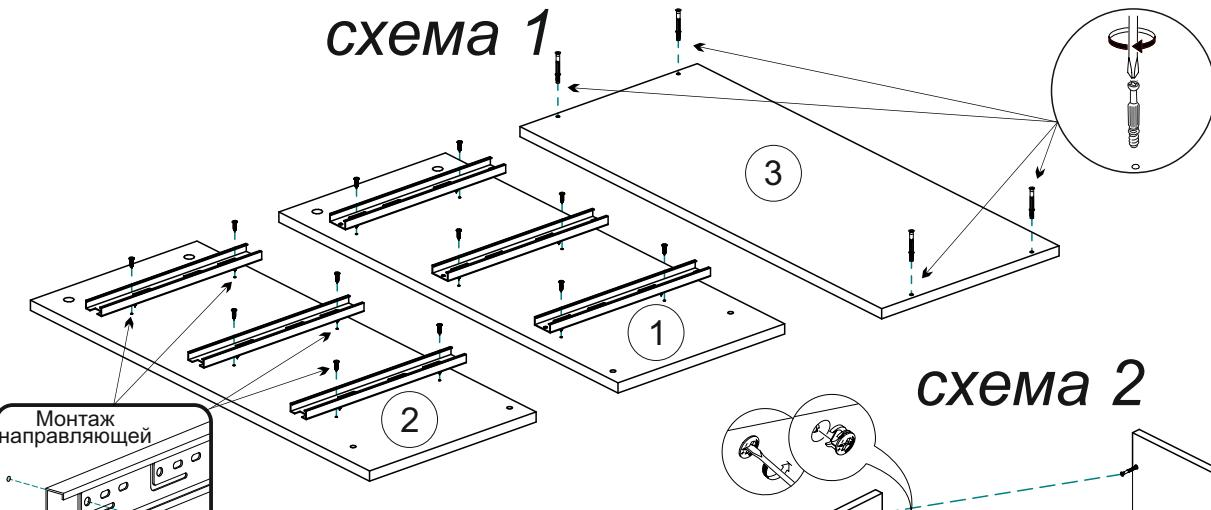
монтаж эксцентриковой стяжки
