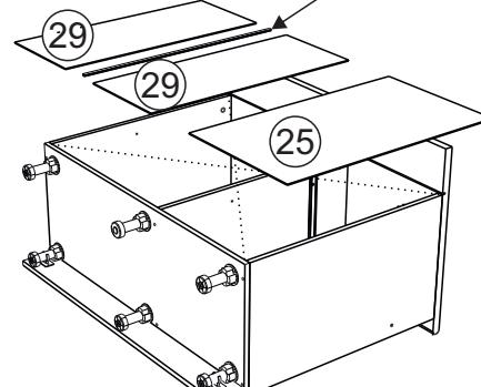
7. Укладываем ДВП (29) в больший проем секции, используя соединительный брус в месте стыка, а ДВП (25) в меньший проем.
