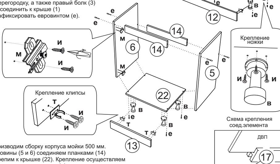
4. Производим сборку корпуса мойки 500 мм. Боковины (5 и 6) соединяем планками (14) и крепим к крышке (22). Крепление осуществляется при помощи еврошурупа (е).
