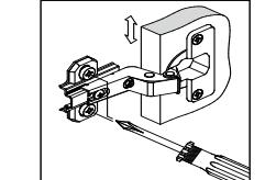
Регулировка по глубине
