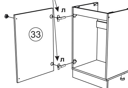
Регулировка положения двери и зазоров
