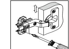
Регулировка по глубине
