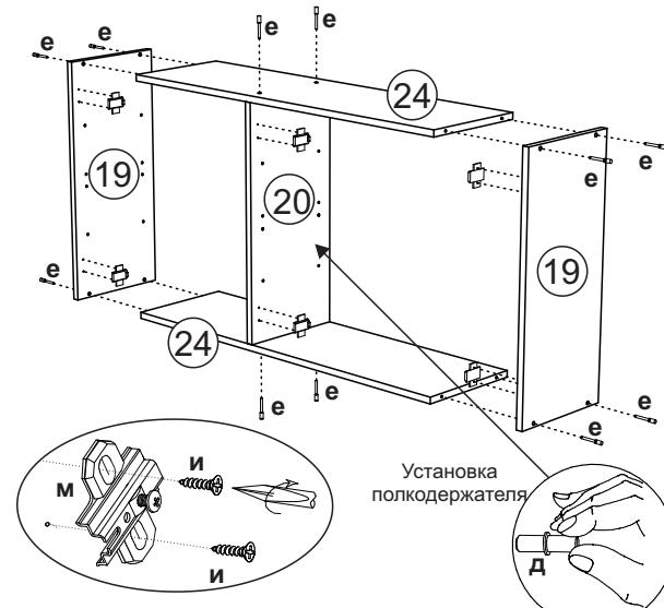
3. Для сборки секции 500 мм боковины (19) соединить с вязками (23) и скрепить евровинтом (е). Обратите внимание, что один из боков не должен иметь планки петель, т.к. на данной секции один фасад.
