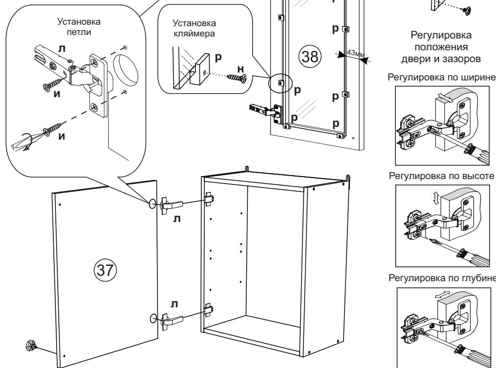
Регулировка положения двери и зазоров
