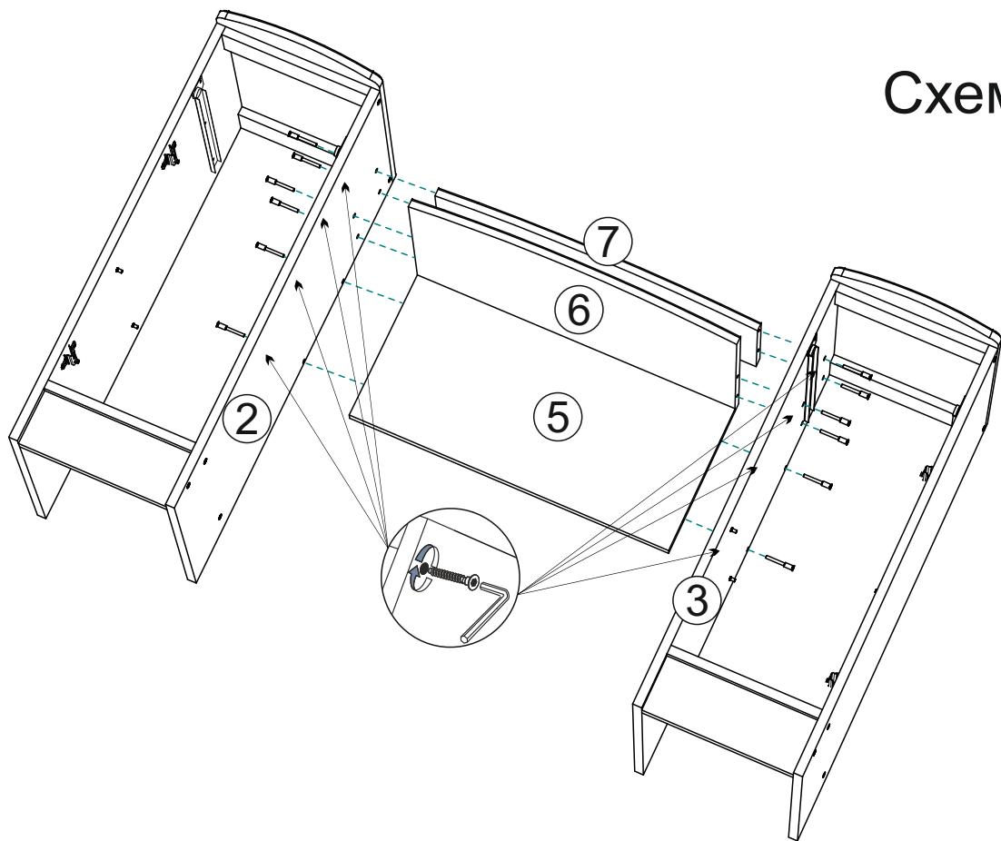
5. Чтобы установить задние стенки (детали №19), необходимо собранную конструкцию перевернуть лицевой стороной вниз. Замерить, с помощью рулетки, и уловнять диагонали ( $a=b$ ). Наложить задние стенки и аккуратно, не нарушая диагоналей, прибить ЛДВП гвоздями, с шагом 130-150 мм, затем так же гвоздями прибейте подпятники на боковины, как показано на схеме 4.
