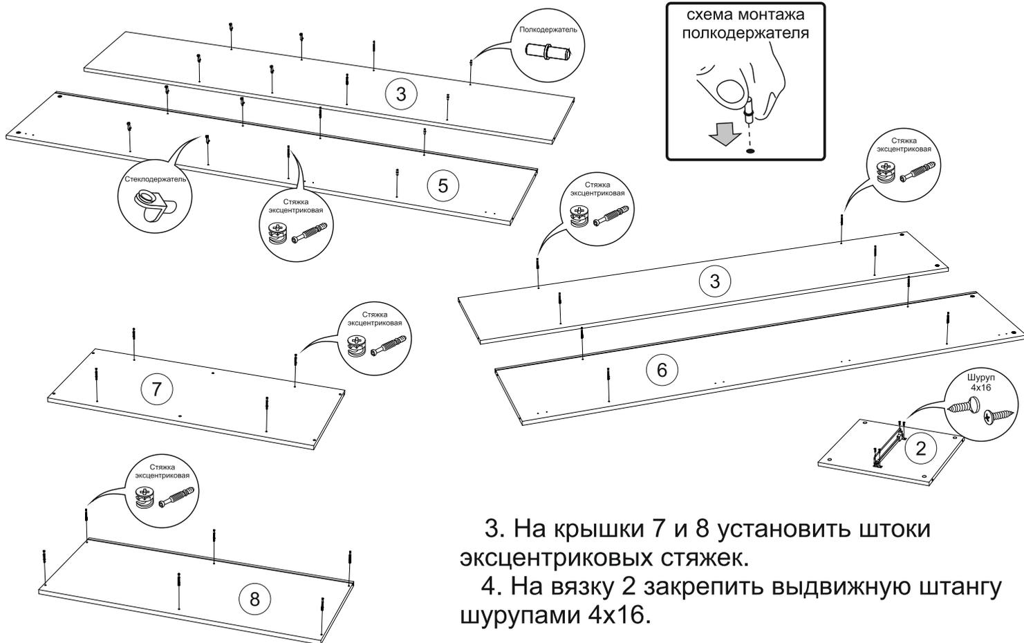
3. На крышки 7 и 8 установить штоки эксцентриковых стяжек.
