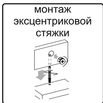
5. Соединить боковины 5, 6 и перегородку 3 вязками 2 эксцентриковыми стяжками, как показано на схеме, предварительно вставив задние стенки 1 в соответствующие пазы.
