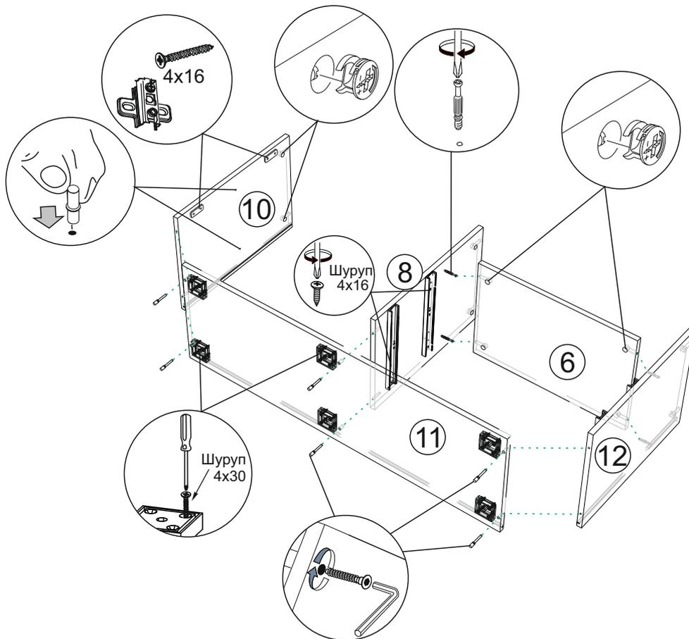
3. Установите тумбу в вертикальном положении. Вставьте в пазы задние стенки №2 последовательно соединив между собой соединительным профилем №16. Затем закрепите крышку №3. Переверните собранную тумбу лицевой стороной вниз, проверьте с помощью рулетки диагонали, уровняйте их и аккуратно, с помощью шурупов 4x16 и уголков RV8, закрепите задние стенки к корпусу тумбы как показано на схеме 2.
