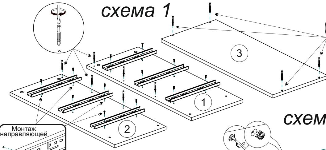
МОНТАЖ ЭКСЦЕНТРИКОВОЙ СТЯЖКИ
