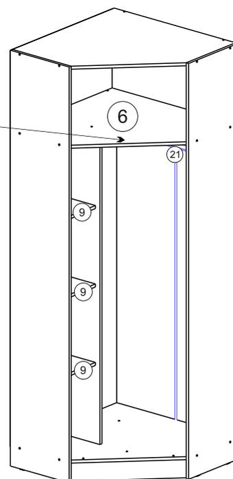
9. Далее необходимо собранную конструкцию поставить на заранее определённое место. Установить штангу №21 и полки №9. Закрепите петли на створках, установите их и отрегулируйте зазоры, используя схемы, представленные выше. Установите толкатели в любом удобном месте, используя схему (схема 8).
