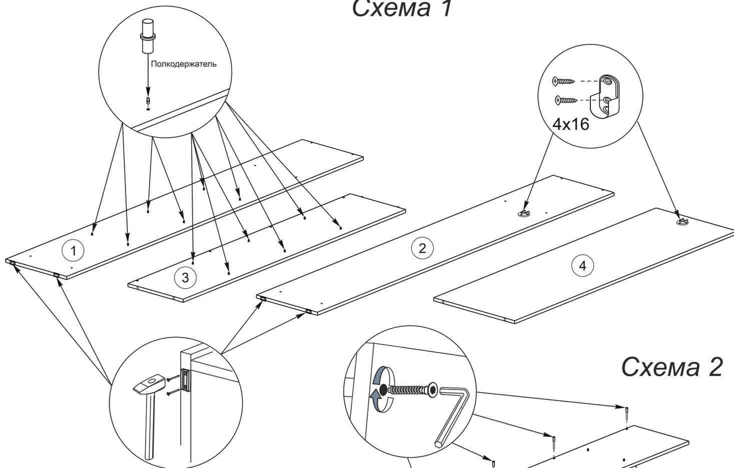
3. Соедините между собой перегородку №3 и панель №4 еврошурупами как показано на схеме 2.
